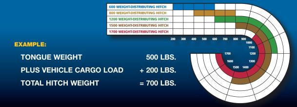
USING THE SELECTOR SHOWN ABOVE, AN 800 WEIGHT-DISTRIBUTING HITCH IS ADEQUATE.
